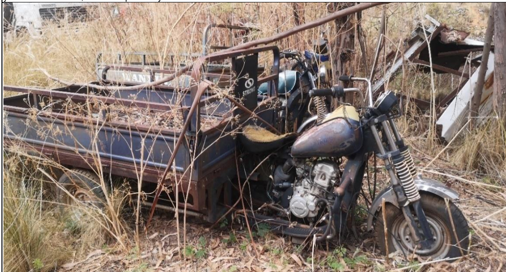
Imagen n.º 9: Vehículo motorizado tipo moto carguero de placa de rodaje EB 9243, se encuentra a la intemperie con los accesorios y carrocería oxidada, estado inoperativo y abandonado.
