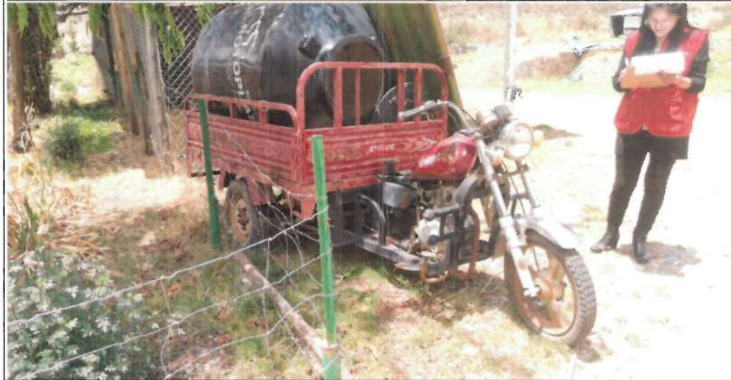
Fotografía n.º 3 y 4: Moto cargueros en estado inoperativo y en abandono por más de dos (2) años, ubicado en la Estación Experimental Agraria Callqui, las cuales se encuentran con los accesorios y carrocería oxidada; situación que coadyuban a su continuo deterioro, y consecuentemente al menoscabo de su valor económico.
