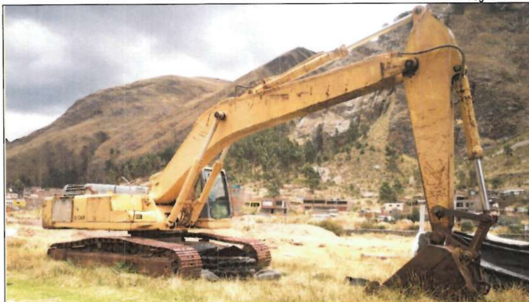
Fotografía n.º 9: Excavadora marca Komatsu en estado inoperativo por más de tres (3) años, se encuentra en abandono a la intemperie, con accesorios oxidados, ubicado en campo ferial de la Dirección Regional de Agraria Huancavelica.
